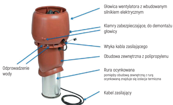
Schemat budowy wentylatora
