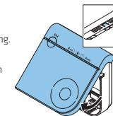
1 Druk op de klem en verwijder het bovenste gedeelte van het onderste gedeelte.
